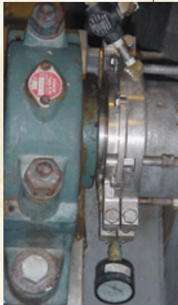
Izquierda y abajo: sello bipartido de la serie AHS, en una mezcladora de listones de procesamiento de especias.
