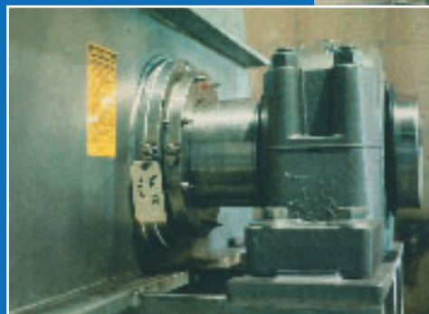
EAS-Dichtung an einem Rührwerk in der Käseherstellung mit 230 mm- Welle (Fotos mit freundlicher Genehmigung der Firma Marion Mixers)
