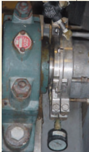
Links/Unten: AHS-Dichtung in geteilter Ausführung auf einem Bandschneckenmischer bei der Verarbeitung von Gewürzmischungen.
