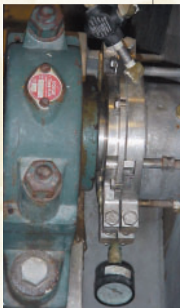
À gauche et ci-dessous : joint segmenté de la série AHS sur un mélangeur à ruban traitant des épices.
